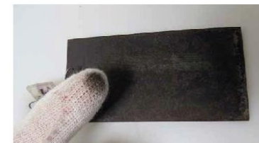
Obr. 15: Tanátový povlak vytvořený z tanátovacího roztoku o vysokém pH nemá dostatečnou stabilitu a zanechává výraznou stopu po otleru
